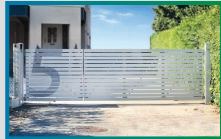
Drehtor 2-flügelig, Amsterdam Profillatte 80 auf dem Rahmen, Oberfläche weiß, außermittige Teilung, Folie mit Hausnummer
