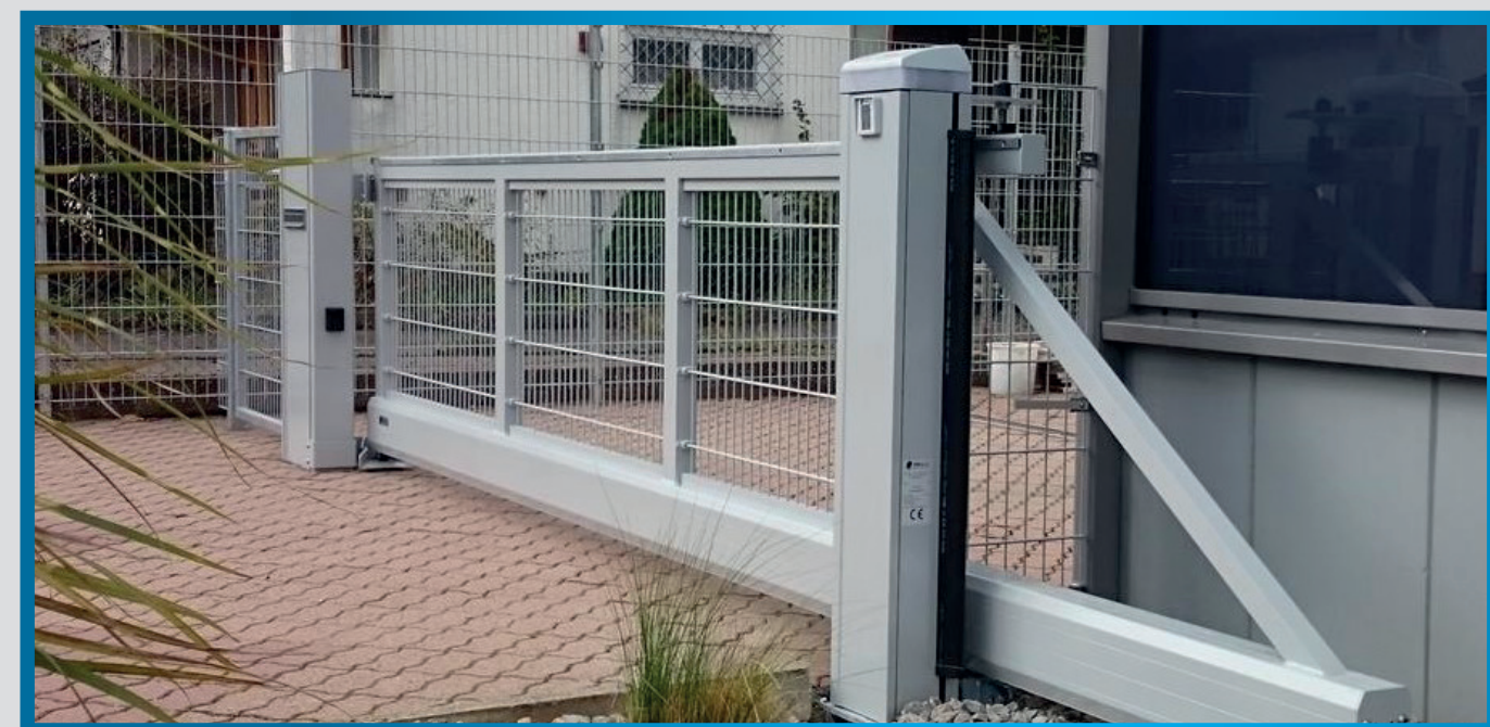
4 m Schiebetor, Doppelstabmatte 50/200, RAL 9006, Inline 100, Briefkastensäule als Einlaufpfosten
