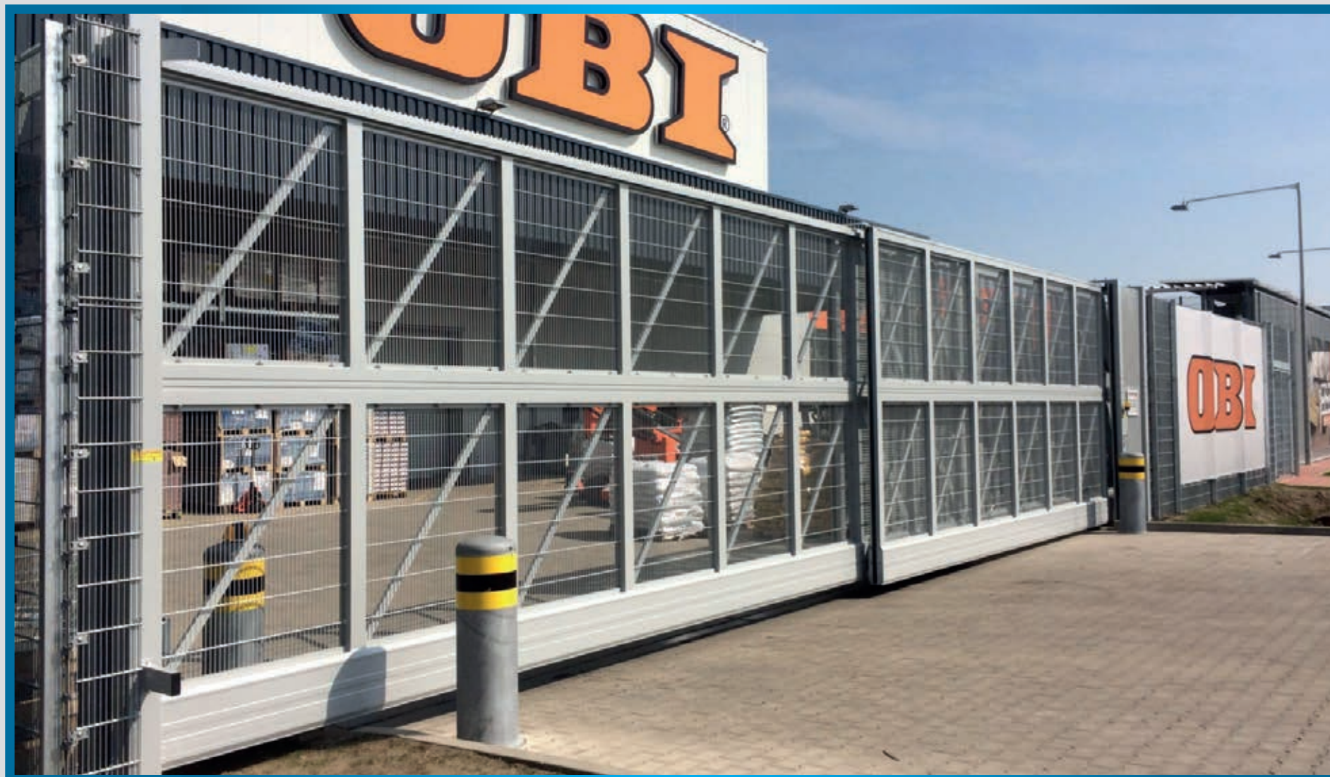
14 m Teleskopschiebetor, Doppelstabmatte 8/6/8 Masche 25/200, Inline 250-T, Höhe 3,50 m (2-geteilt in der Höhe) RAL 9006
