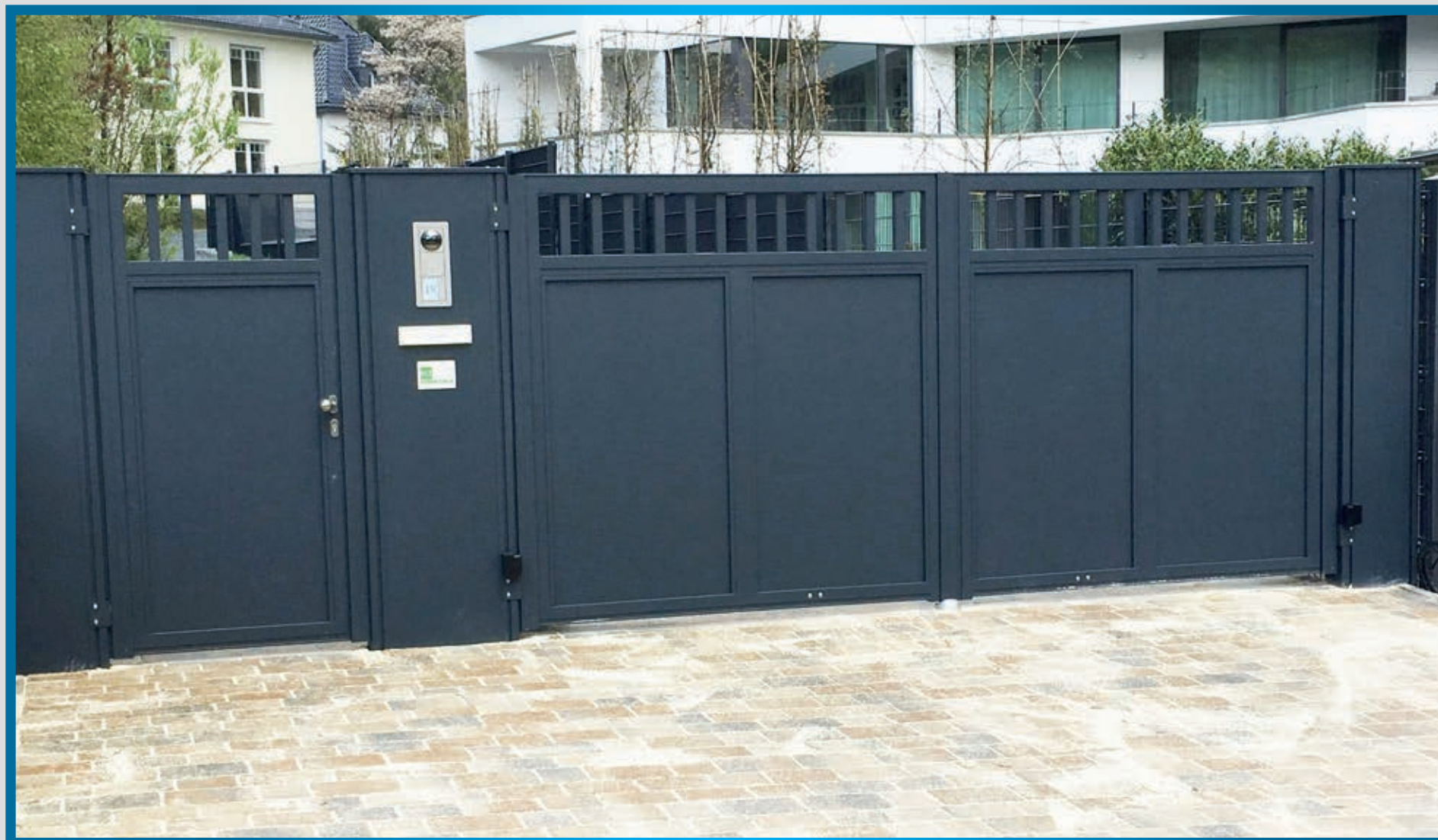
3,86 m Drehtor 2-flügelig mit Anschlussstür, Glattblech mittig im Rahmen, Oberhalb Profil 40x30, RAL 7016 Feinstruktur, Bedien- und Briefkastensäule als Haltepfosten,
