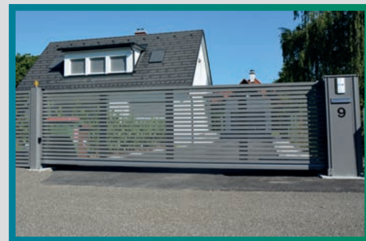
6 m Schiebetor, Amsterdam Profillatte 80 auf dem Rahmen, Oberfläche grau, Extern 100, Briefkastensäule als Einlaufpfosten, Zaunfeld im Rückfahrbereich.
